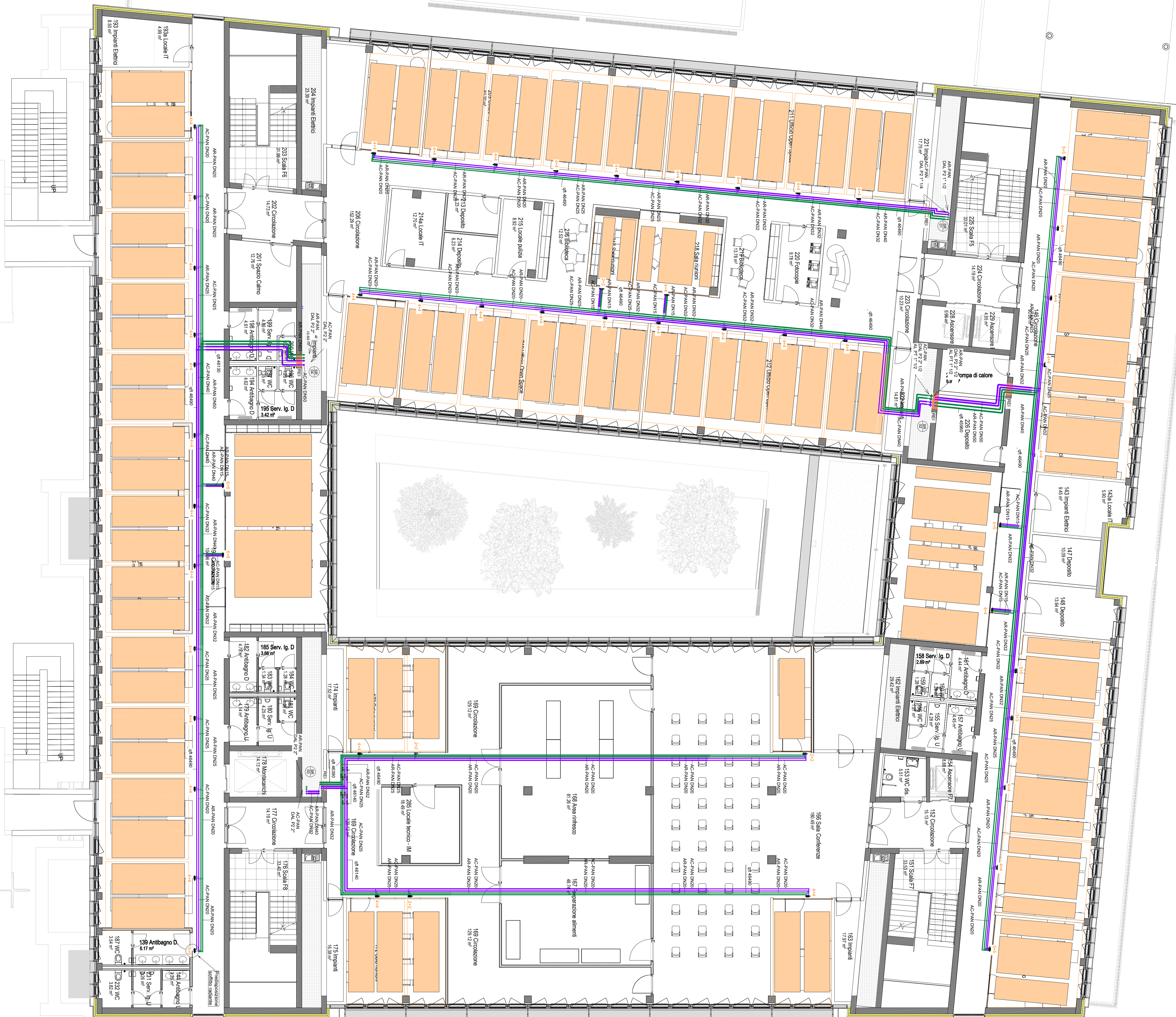
Planimetria Piano 1° - Sistema Radiente a Soffitto 1 : 100
